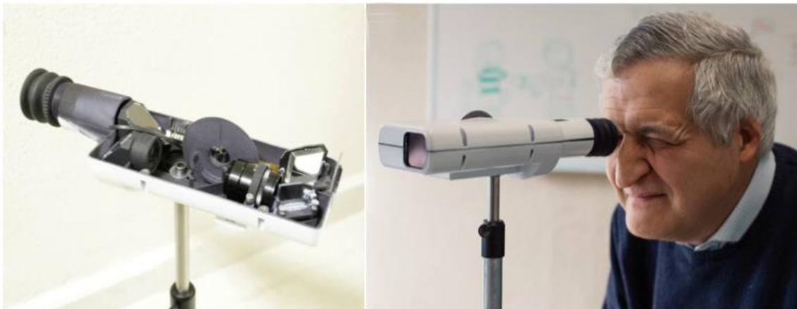
Interior del prototipo SimVis (izquierda) y un sujeto testando esta tecnología (derecha). / CSIC
